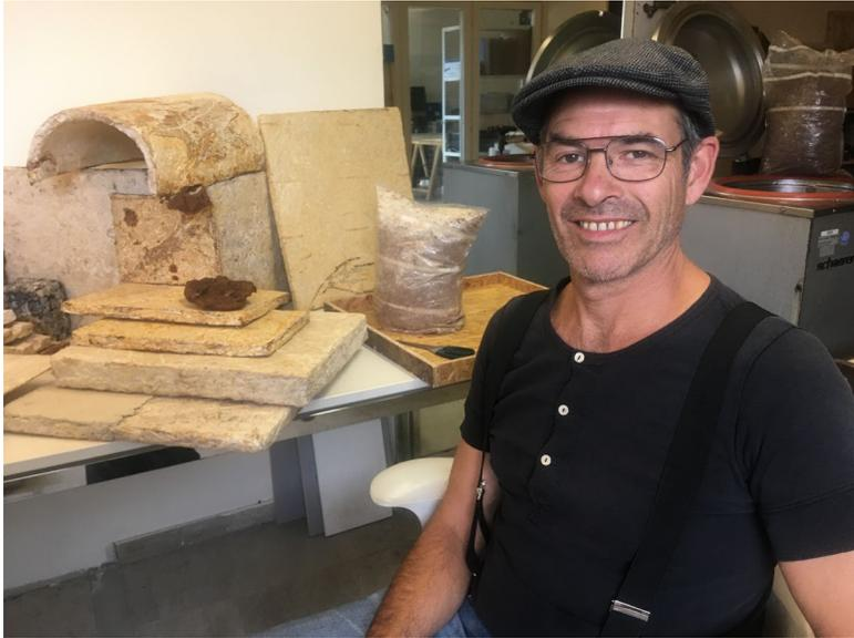
*Patrick Mürner im Pilzlabor mit Produkten aus Mycelkompositen. (Bild: P. Mürner)*
